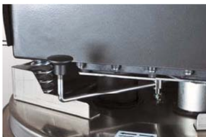
Páka spätného prietoku pre automatické čistenie filtra. Back flow lever for automatic filter cleaning.
