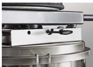
Páka na vypúšťanie kvapalín. Lever for liquids turn out.
