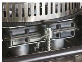
Páka spätného prietoku pre automatické čistenie filtra. Back flow lever for automatic filter cleaning.
